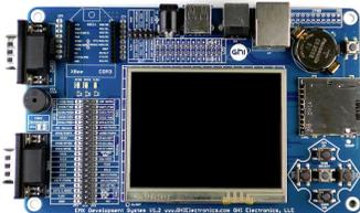
Le processeur sur l'EMX contient nativement la couche Ethernet avec les transferts DMA, ce qui accélère très nettement en comparaison du classique chipset SPI utilisé par les autres.
