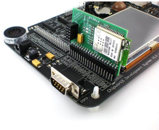
Comme on l'a vu précédemment, USBizi (FEZ) peut être utilisé avec des modules qui contiennent en interne une pile TCP/IP et le support des sockets, comme l'extension de SparkFun, qui contient le module WiFly de Roving Networks.
