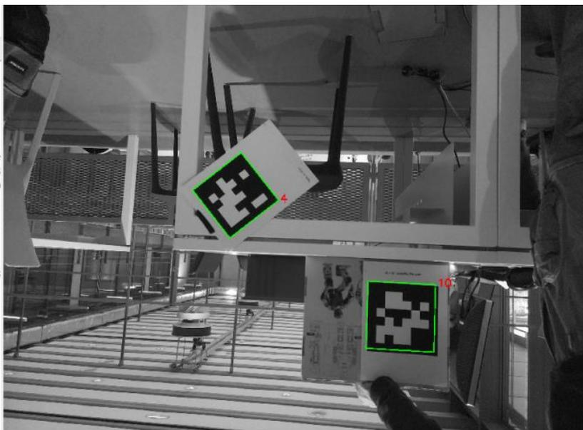
Figure 8 : Résultat obtenu par l'exécution du programme detectionApriltags.py
