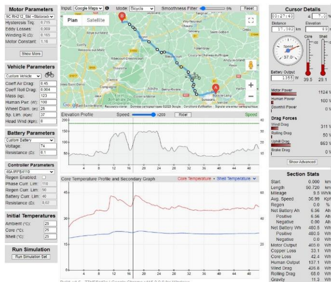
Figure 4 : Estimateur de consommation et de température moteur d'un vélo couché à une vitesse moyenne de 37km/h.
