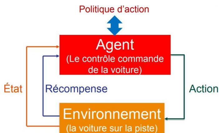
Figure 3 : Schéma explicatif de l'apprentissage par renforcement
