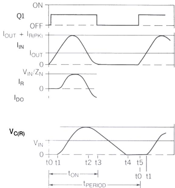
Fig. 2 - Quasi-Resonant Waveforms
