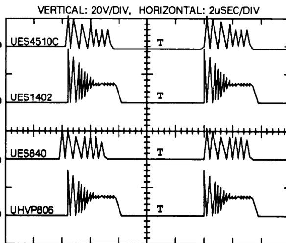
Fig. 20 -- Catch Diode Ringing
