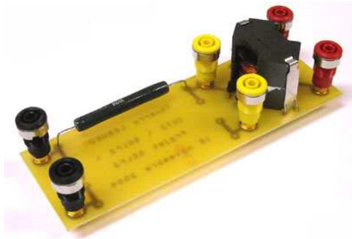
Figure 12.11. Inductance RM14 3F3 + résistances (images-maquettes\self3-13.jpg).
