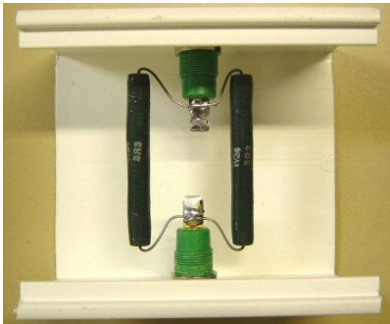
Figure 12.7. Résistances de puissance 3R3 W24 (images-maquettes\RL-1650-22.jpg).
