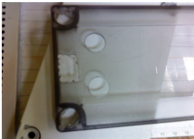
Illustration 19: Couvercle du boîtier percé
