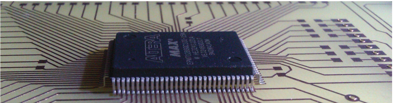
Illustration 23 : CPLD utilisée pour le projet déposée sur la carte électronique
