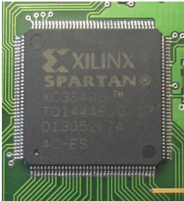
Illustration 19: CPLD monté CMS (Circuit monté en surface)
