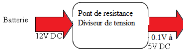
Illustration 7: Schéma fonctionnel du pont de résistance
