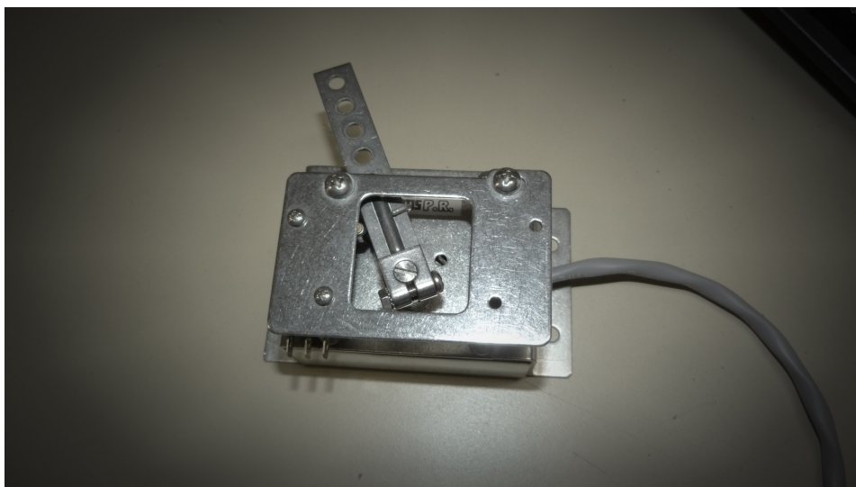
Illustration 11: Potentiomètre mécanique - pédale de frein
