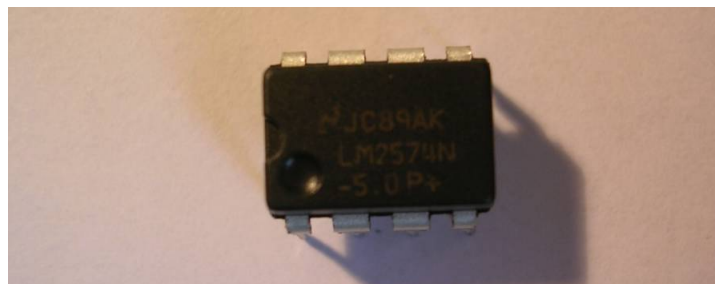
Illustration 11: Le régulateur de tension LM2574N-5[3]
