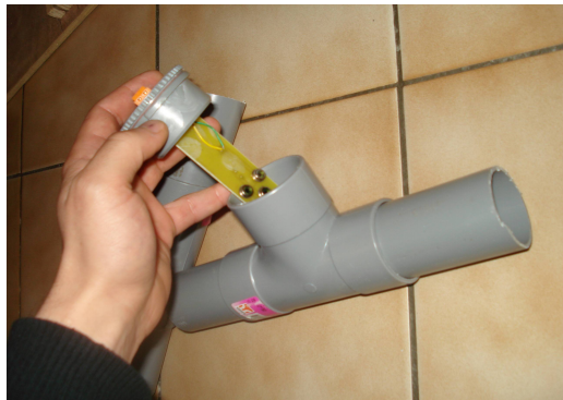
Illustration 46: Mise en place de la carte photodiode
