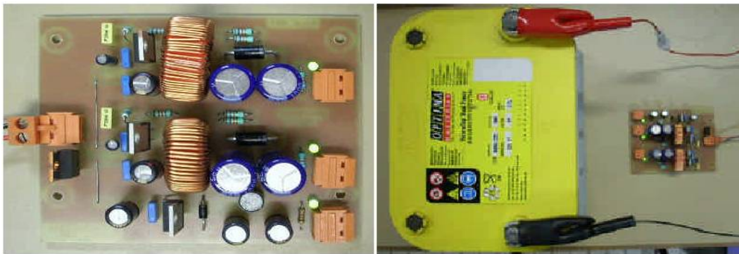
Illustration 9: Carte d'alimentation des bornes: +12V vers +5V & +15V
