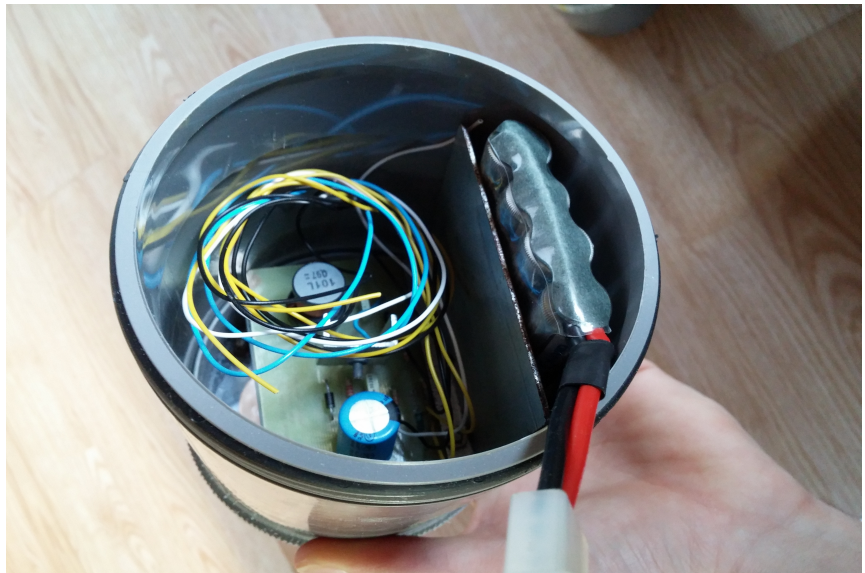
Illustration 24: Intérieur du boîtier avec l'emplacement de la batterie et les cartes électronique [1]
