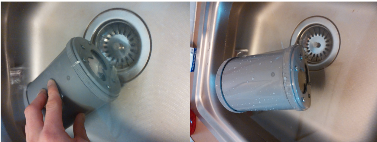
Illustration 25: Tests d'étanchéité du boîtier de la lampe [1]
