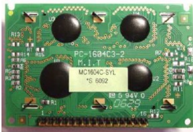
Illustration 8: Circuit et connectique de l'afficheur
