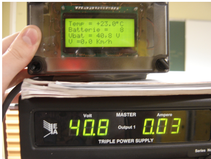
Illustration 23: Visualisation de la tension des batteries
