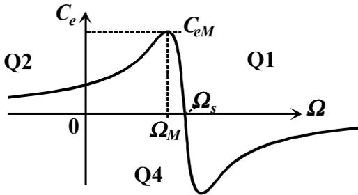
Couple maximal  $C_{eM}$  obtenu pour  $g_M = R_2 / X_2 = 1,8\%$  à la vitesse angulaire  $\Omega_M = (1 - g_M) \Omega_s$ , soit :
