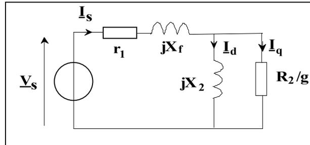
il représente un modèle par phase d'un moteur asynchrone triphasé, différent de celui habituellement utilisé en régime permanent.
