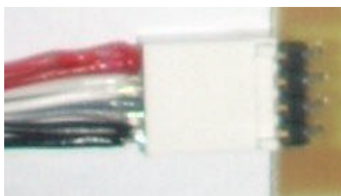
Figure 1.2. Câblage du connecteur I2C (images-maquettes\ATmega8535-613.jpg).
