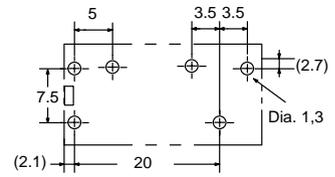
Modèles bistables deux bobines avec cosses pour c.i.
