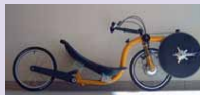
Le Vélo couché avec le plateau en fibre de carbone de 125 dents.
