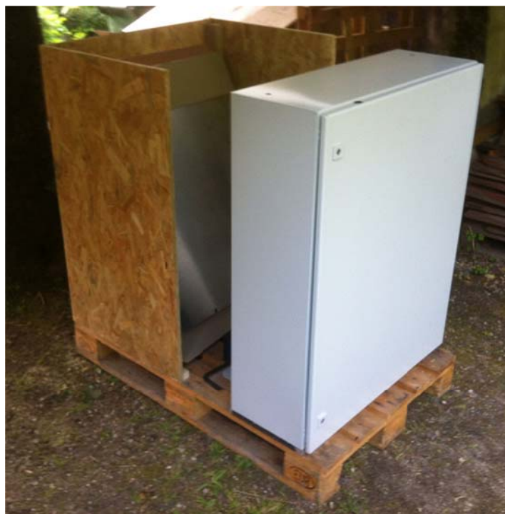
Figure 1. L'armoire électrique fixée sur la palette EURO avec son caisson.
