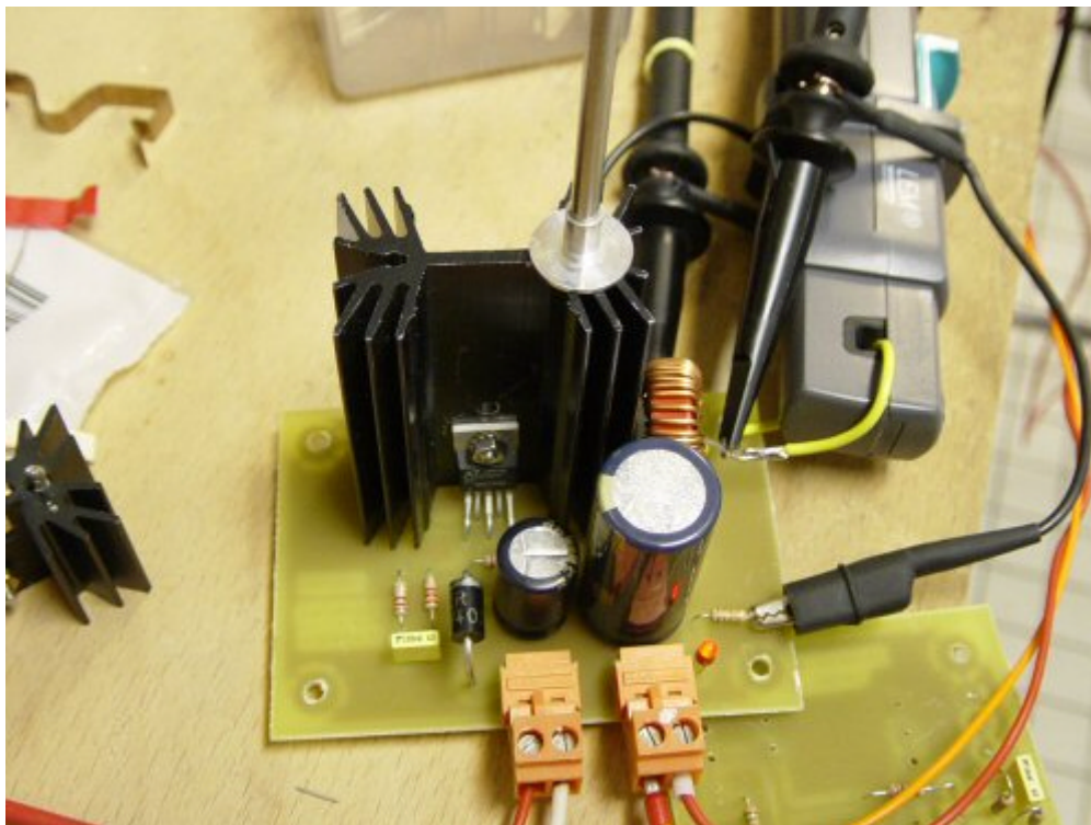
Fig. 2.6. Mesure de température du LT1074 avec I_s = 4,5A (ALIM1074\2006-03-03\DSC00585-b.jpg).
