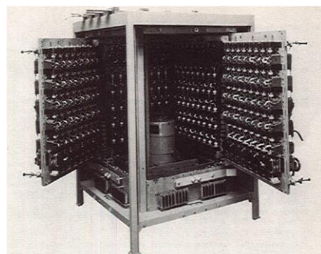
Figure 1b : locomotive BB16685 4,1 MW, bloc de puissance à thyristors, 2x1900 A 1100 V, marche et récupération, doc Alstom
