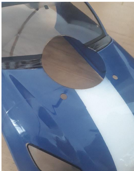
Figure 3 : Découpe du passage du lidar au laser
